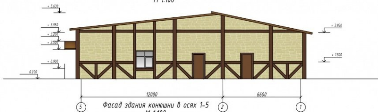
Фасад здания конюшни в осях 5-1 М 1:100
