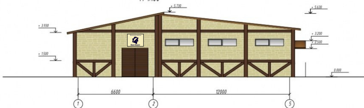
Фасад здания конюшни в осях 1-5 М 1:100
